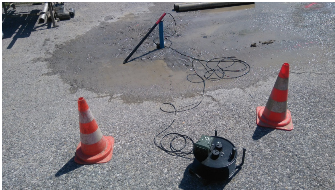
Figure 3 : Détecteur VX1 et magnétomètre au droit d'un forage.
